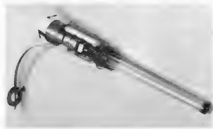
Bild 5. Elektronenstrahlssystem der Kidocolor-In-Line-Farbbildröhre von Hitachi (Aufnahme: Schwahn)
