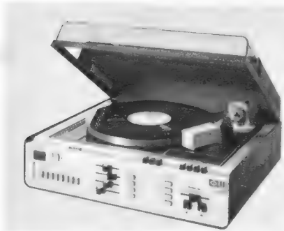
◀ Bild 3. Kombinations-MDR-Video-Gerät L 522 von Rabe, bestehend aus einem Gerät zur Aufnahme und Wiedergabe von Fernsehprogrammen mit der magnetischen Platte, Fernseh-Tuner für VHF und UHF, UKW-Empfangsteil, 2 x 20 W-Verstärker und Aufnahme- und Wiedergabeeinrichtung für Stereo
