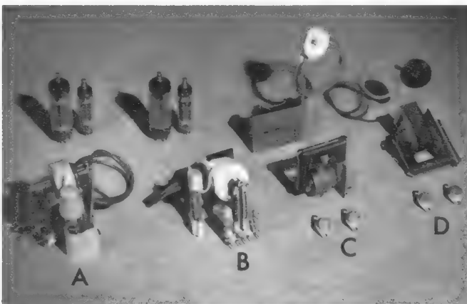
◀ Bild 5. Erzeugung der Hochspannung durch Gleichrichtung mit Röhre (A), mit Selen-Gleichrichter (B), Spannungsverdoppler oder Kaskade (C) und Zeilentransformator mit „integrierter“ Silizium-Diode (D)
