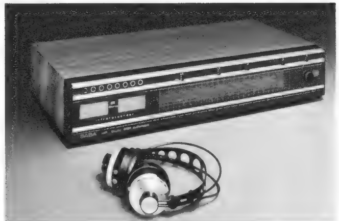
Bild 13. ▶ Einen eingebauten Infrarotsender hat das Steuergerät Hi-Fi-Studio 8101 von Saba
